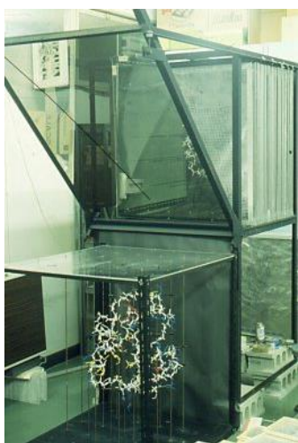
図2. リチャードボックス 斜めにあるのがハーフミラー、その下が分子モデルで、奥が電子密度。
